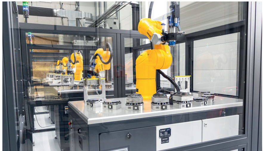
Präzision in Serie: Fünf Roboter polieren Keramikspangen für Gangwahlhebel. Die Anlage läuft voll automatisiert. (© Blum-Novotest)
